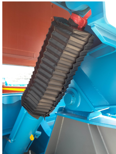
写真 3 エンドフォールディング式ハッチカバー用蛇腹式カバー（開発中）
