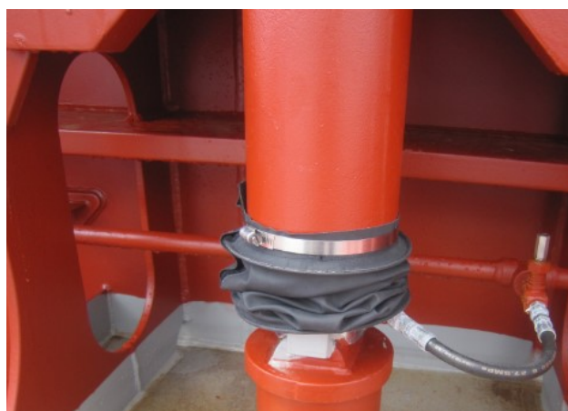
写真 1 サイドローリング式ハッチカバー用蛇腹式カバー
