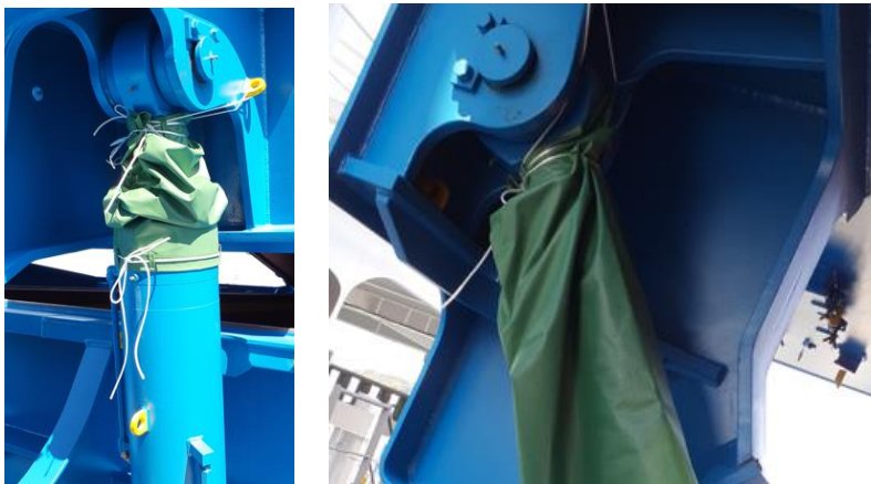
写真 1 エンドフォールディング式ハッチカバー用保護カバー
